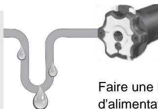
Faire une boucle sur le fil d'alimentation pour éviter que l'eau de pluie ne s'infilte dans la tête moteur.
