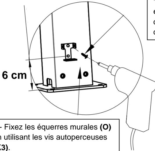
2 - Fixez les équerres murales (O) en utilisant les vis autopercuses (K3).
