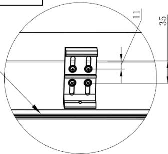
**Attention !!!** Percer les trous sur la poutre du côté extérieur, comme indiqué sur le schéma ci-dessous, afin d'éviter d'endommager la rainure d'évacuation des eaux.
