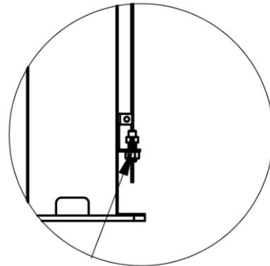
3 - Vissez le contre-écrou en pression afin d'ajuster la tension du câble.
