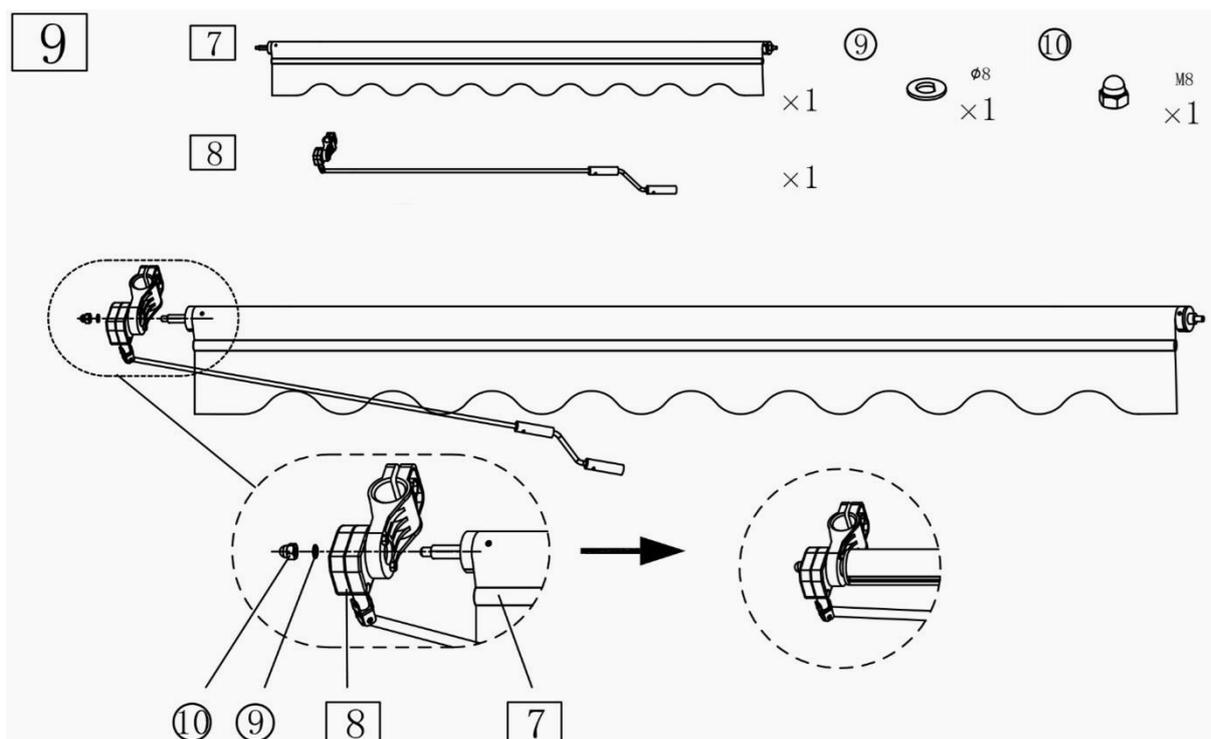
Fixez la partie de manœuvre sur le tube d'enroulement. Comme sur le schéma 9.
