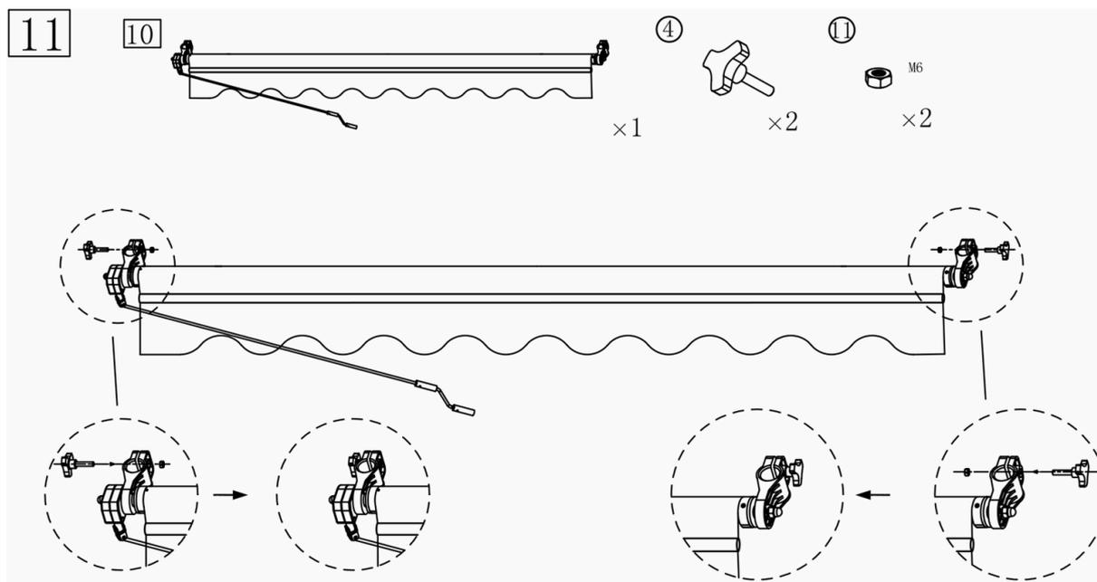
Resserrez les vis de blocage [4] du montant de support. Comme sur le schéma 11.
