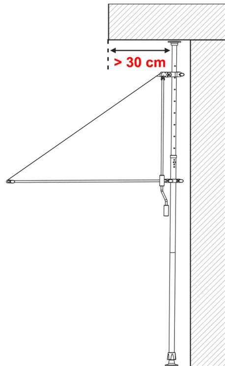
L'installation doit être effectuée en stricte conformité avec les règles de sécurité applicables aux chantiers, afin de garantir la sécurité des personnes. Si le store doit être installé à un étage supérieur au rez-de-chaussée, la zone concernée doit être délimitée et surveillée pour qu'aucune personne ne se trouve sous le lieu d'installation.
