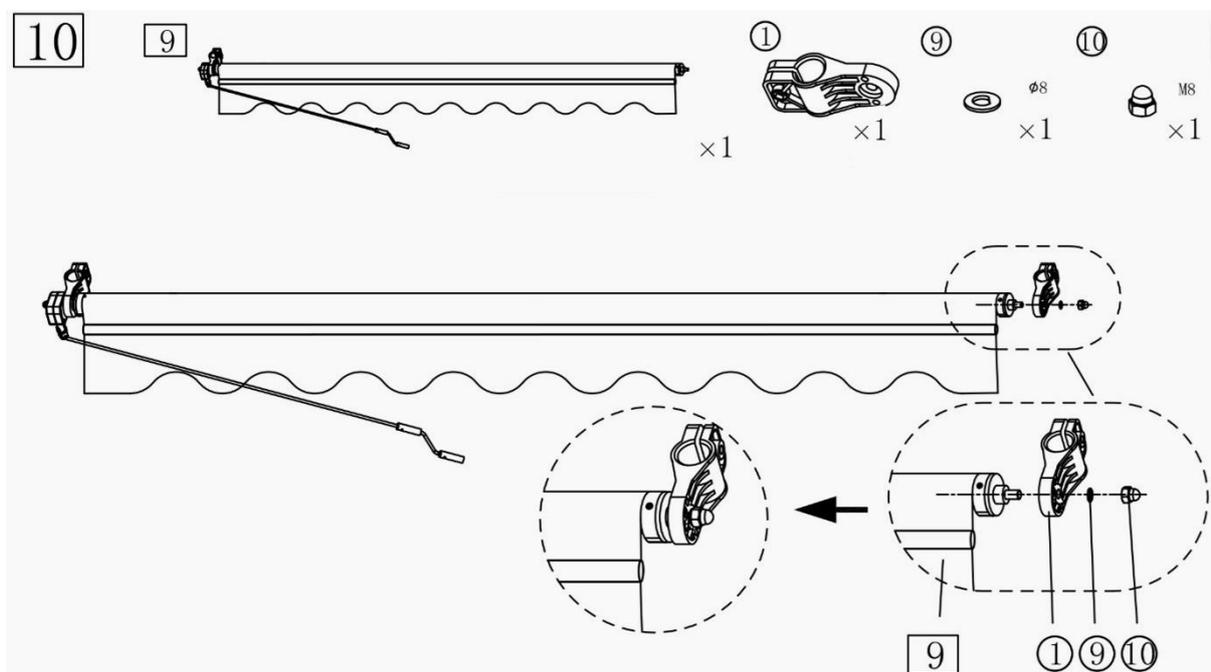
Fixez l'opposé de la partie de manœuvre sur le tube d'enroulement. Comme sur le schéma 10.
