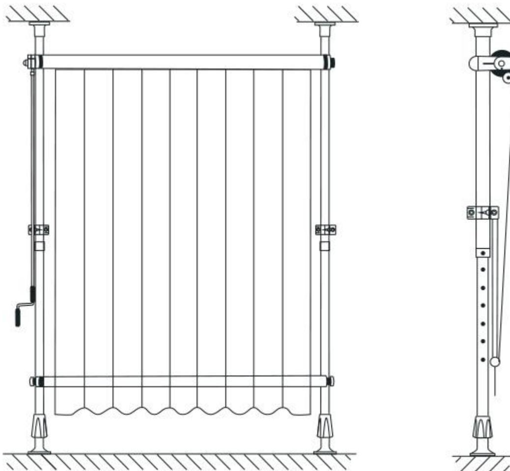
**ATTENTION !!!** Veuillez à ce que la toile du store soit toujours entièrement rentrée afin d'empêcher que le store ne se déroule en raison d'une force extérieure comme le vent par exemple. Le treuil n'est pas équipé d'un dispositif de blocage.
