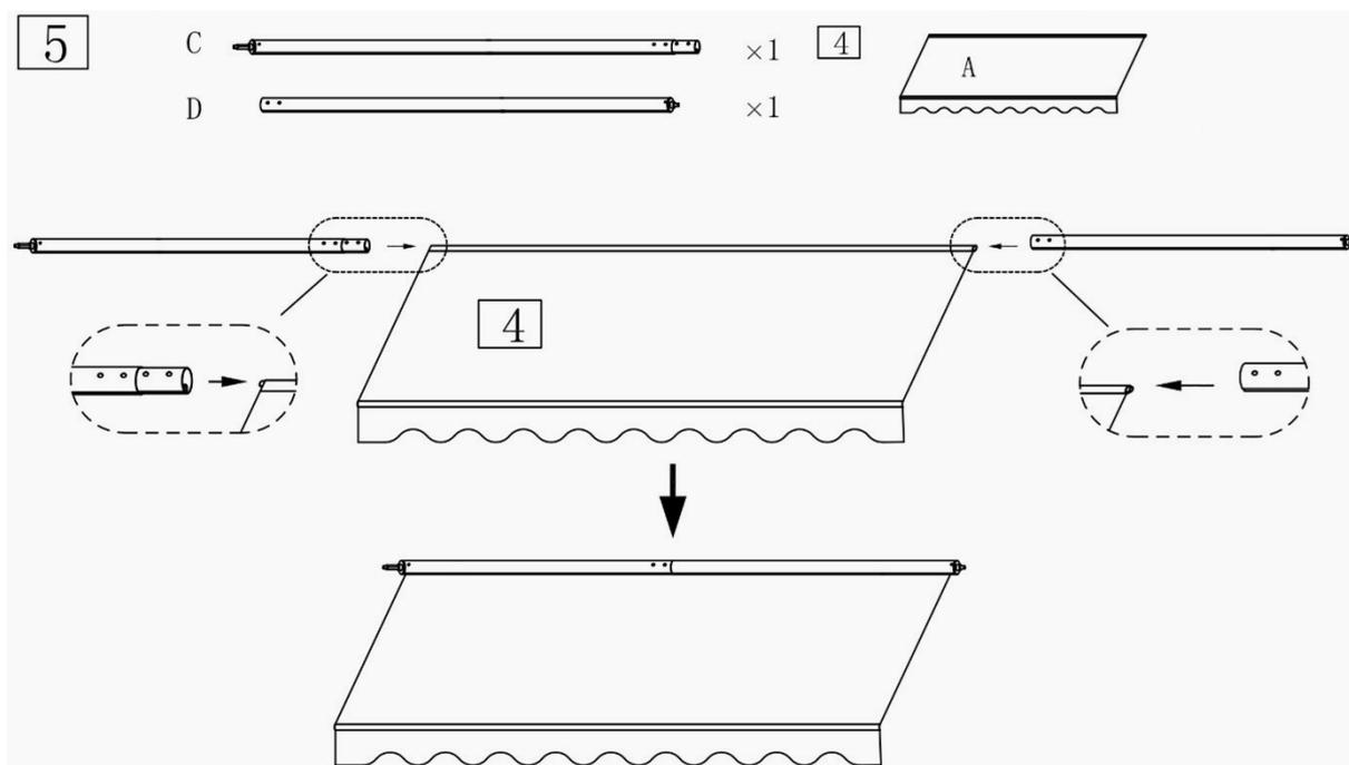
Glissez la toile (ourlet haut dans lequel le jonc est inséré) dans la rainure du tube d'enroulement [C] et [D]. Comme sur le schéma 5.
