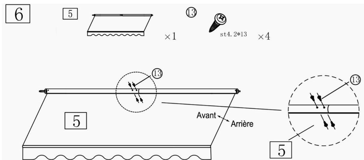
Serrez les 4 vis [13] afin de coupler les parties du tube d'enroulement. Comme sur le schéma 6.
