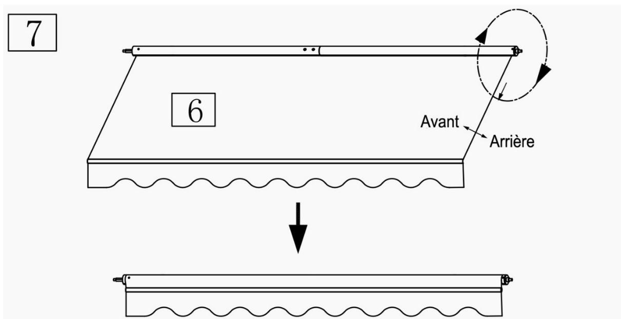
Enroulez la toile sur le tube d'enroulement. La toile doit s'enrouler toujours par dessus du tube d'enroulement. Comme sur le schéma 7.
