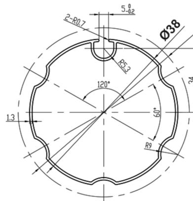
**Remarque :** tube d'enroulement de 38 mm de diamètre. Fabriqué en 100% aluminium extrudé (non en acier).
