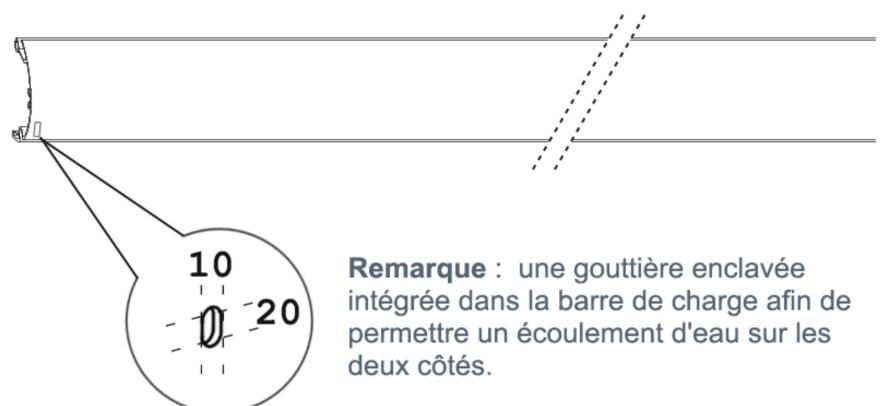
**Remarque :** une gouttière enclavée intégrée dans la barre de charge afin de permettre un écoulement d'eau sur les deux côtés.
