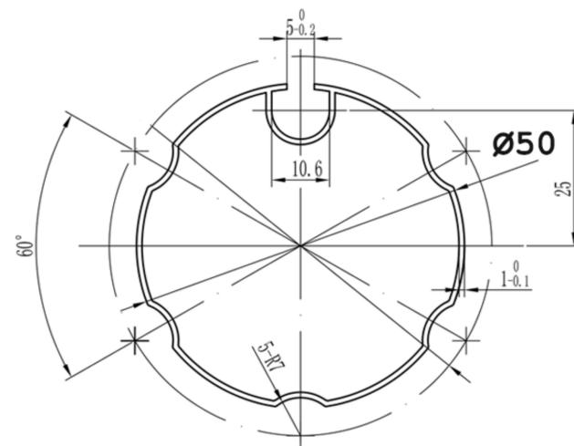
**Remarque :** Le tube d'enroulement est fabriqué en 100% aluminium. Le diamètre de Ø50.
