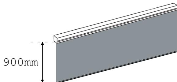
Lambrequin enroulable manuel : Avec une hauteur enroulable de 900 mm max.
