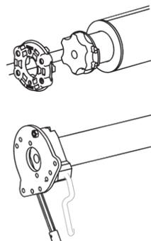
Moteur tubulaire adapté au couple de déverrouillage des bras.
